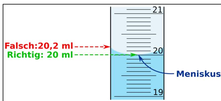
**Abbildung 1:** Richtige Einstellung des Meniskus auf die Oberkante der Füllhöhenmarkierung.
