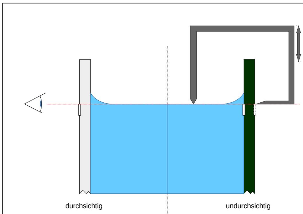
**Abbildung 2:** Richtige Ablesung der Füllstrichhöhe: Füllstrich-Oberkante in einer horizontalen Sichtlinie mit der Meniskus-Unterkante. Rechte Bildhälfte: Für undurchsichtige oder anderweitig problematische Gefäße kann ein höhenverstellbaren Parallelabnehmer mit einer Prüfspitze eingesetzt werden; ein innenliegender Füllstrich wird dann von einer benetzenden Flüssigkeit vollständig überdeckt.
